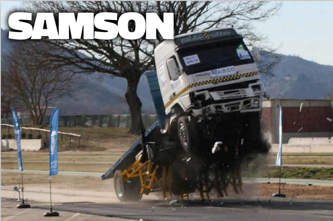
**Samson ist eine modulare und mobile Barriere, die Lastwagen mit einem Gewicht von bis zu 12 Tonnen stoppt**
